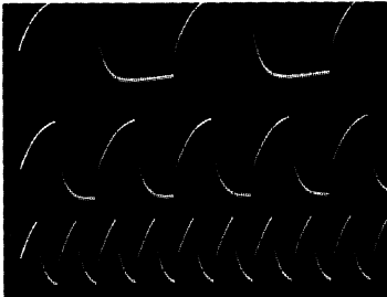
Fig. 14-21. — Attaque en signaux rectangulaires de l'amplificateur de la figure 14-15. Trace supérieure 50 Hz. Trace du milieu : 100 Hz. Trace inférieure 200 Hz.
