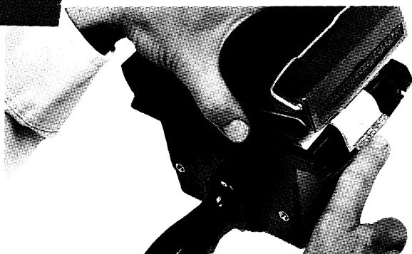
Fermer la partie mobile du dos en laissant dépasser les languettes. Encliqueter le clips et retirer le papier noir. La première photo peut être prise.
